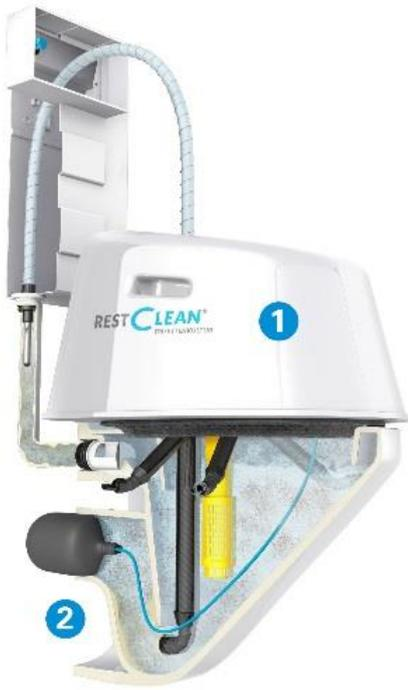
Querschnitt – Anschauungsmodell: Gerät im Einsatz auf WC-Anlage (1-Reinigungsgerät mit Umwälzpumpe und Spüldüsen / 2-Verschlussballon zur Abdichtung Siphon)
